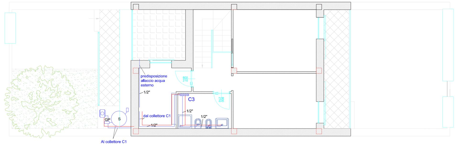
Layout rete idrica e ACS primo piano, scala 1:50
